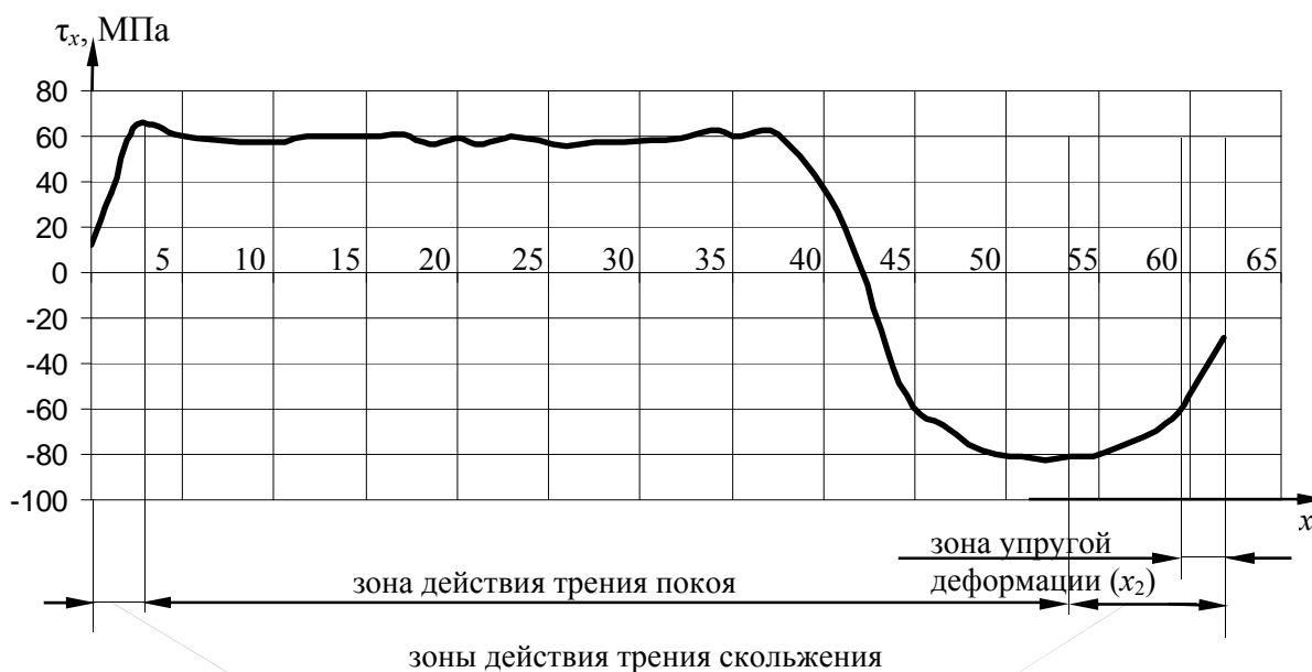
Рис. 2. Графики распределения касательных контактных напряжений по длине очага деформации 1-й клетки 6-клетевого стана горячей прокатки «1700», полученные с помощью программы Deform-3D
